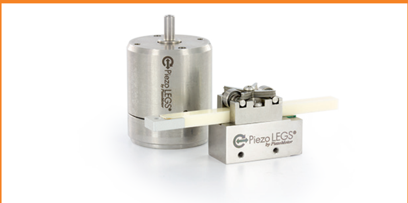
Piezo LEGS® har en rörelseprecision på miljondels millimeter. Motorns piezokeramiska ben lyfter omkring 1 000 gånger sin egen vikt. Den linjära motorn på bilden är cirka 22x19x11 mm stor.
